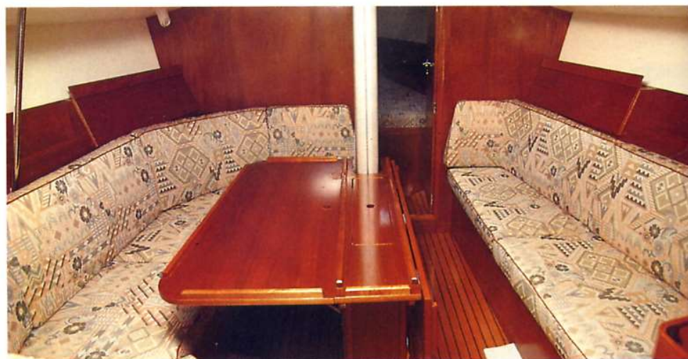
La dinette del Sun Fast 36 mostra un tavolo centrale ad ante abbattibili che, aperto, misura cm 120x110. Due robuste rotaie permettono al piano di sinistra di scorrere verso il basso, così da creare una cuccetta doppia. Nella versione a tre cabine, la panca di dritta è lunga solo cm 174 (una cuccetta di riserva per un bambino. Il Makorè, un legno simile al mogano, è lavorato con molta cura.
