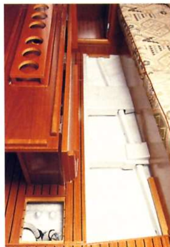
Il controstampo poggia su madieri resinati a scafo e serve solo a sostenere il pagliolato; le pompe di sentina pescano in un vano apposito.
