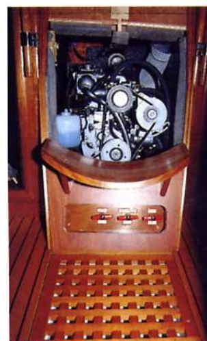
L'accesso frontale al 28 cv Yanmar è buono, sui lati è invece limitato. Da notare l'utile grigliato ai piedi della scaletta.
